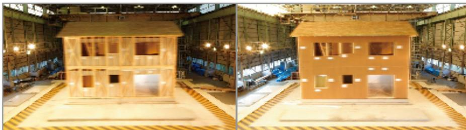
＜「耐震構造体」加振全景(左)＞ ＜「耐震+制震の構造体」加振全景(右)＞
