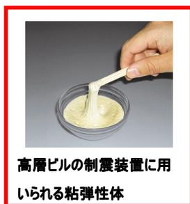
1階から3階の柱・間柱・梁・土台の建物外周部に粘弾性体の施工をします。
